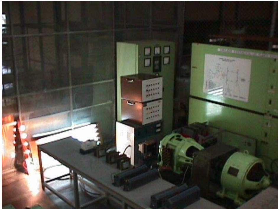
Figura 3.11. Vista de las cargas estáticas y dinámicas con el tablero de control
